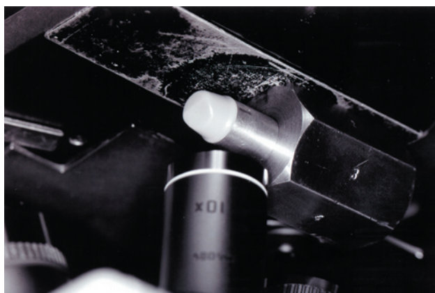
Figura 4. Leitura do desajuste da adaptação marginal pelo microscópio óptico
