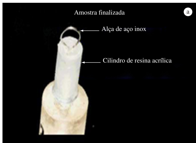
Figura 1. a) Cilindro de resina acrílica com alça para adaptação na máquina de ensaio universal; b) Amostras posicionadas para o ensaio de resistência à tração.
